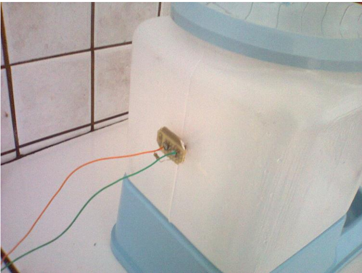
Figura 11: Sensor de água no bebedouro
