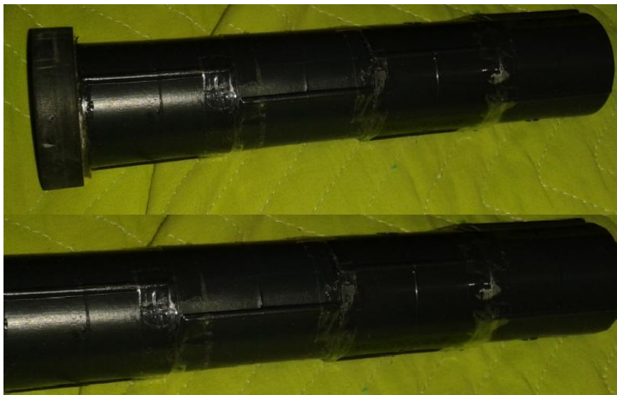
Figura 15 - Eixo da esteira com rodinhas de impressora
