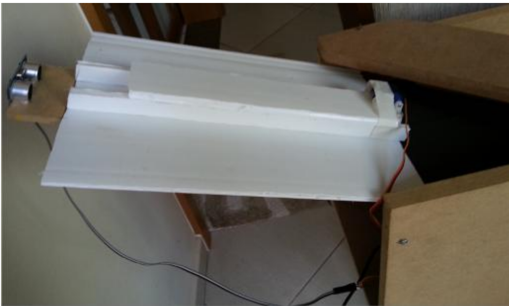
Rampa de despejo das chaves
