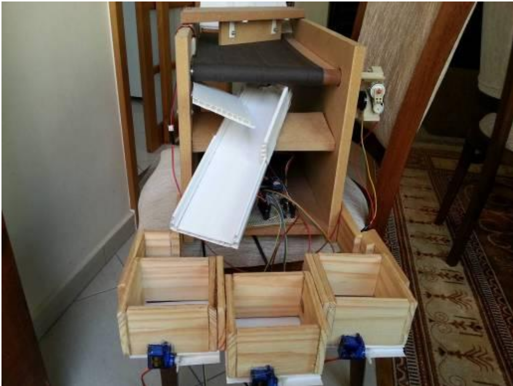
Rampa seletora e as caixas de armazenamento
