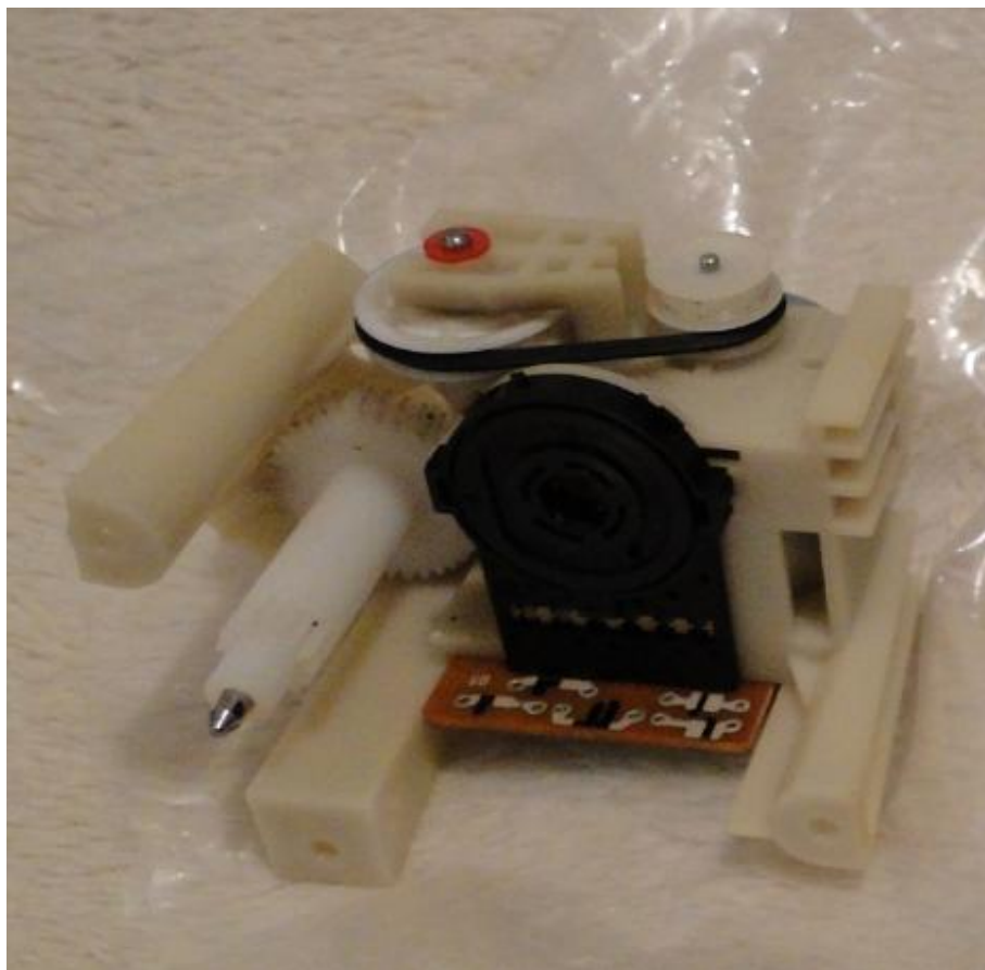
Motor de videocassete para utilizar no movimento da esteira
