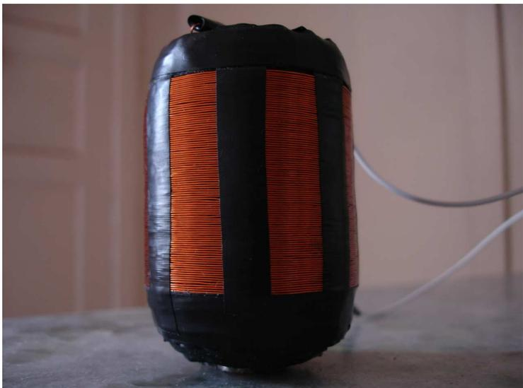
**Figura 6: Eletroímã - Núcleo de Ferro Doce e o enrolamento de cobre**
