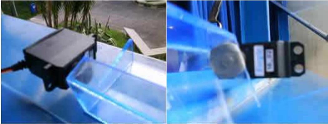
Figura 08 – Servo-motor fixado na calha de chuva. Fonte: Autores do projeto.
