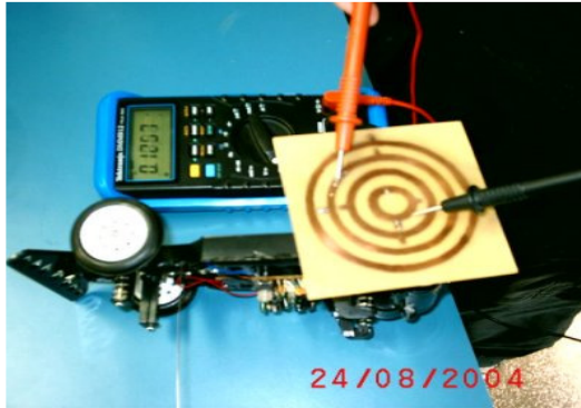
O teste para ter certeza de que a bobina geraria tensão.
