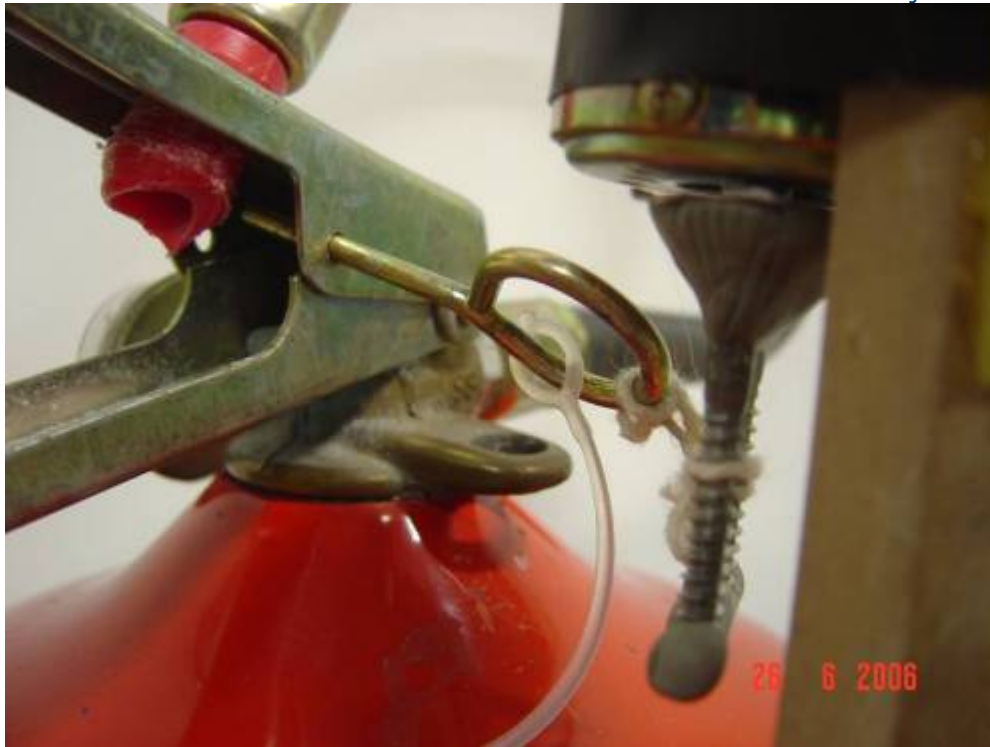
FIGURA 14 - DETALHE DA RETIRADA DA TRAVA DE SEGURANÇA
