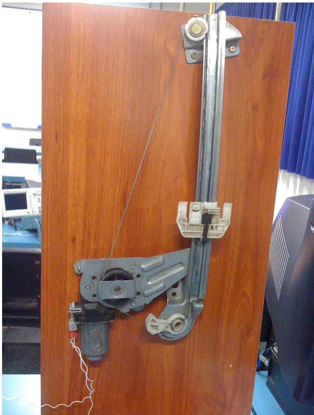
Figura 1: *Sistema de um vidro elétrico auto-motivo adquirido para elaboração do projeto.*
