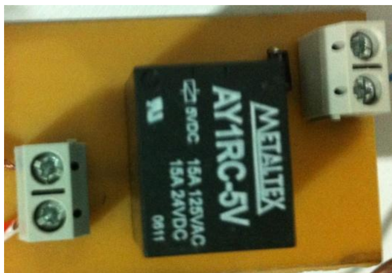
Figura 11: Placa contendo o relé.
