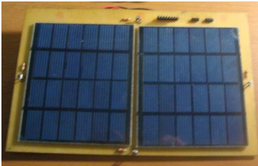
Figura 10 – Células fotovoltaicas na PCB
