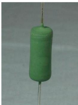
Figura 1 – Resistor de fio de 5W utilizado no projeto.
