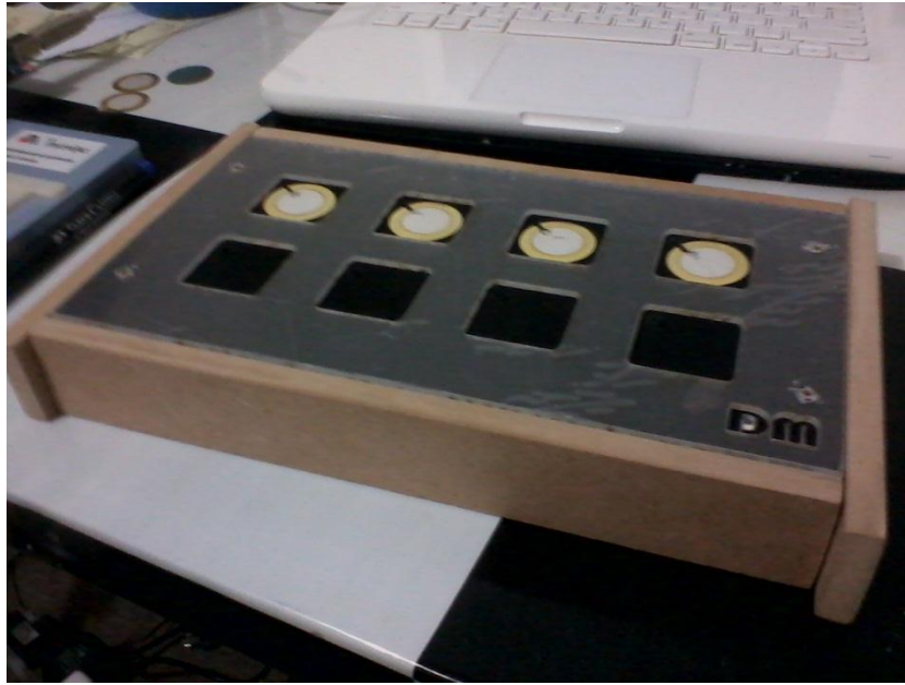
Figura 13 – Pad's de borracha sendo colados em cima dos piezos, para proteção
