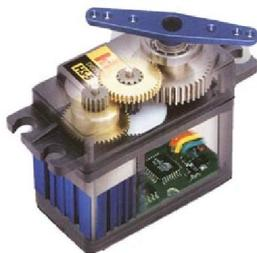
Servo motores são dispositivos de malha fechada, ou seja, recebem um sinal de controle; verificam a posição atual; atuam no sistema indo para a posição desejada. Em contraste com os motores contínuos que giram indefinidamente, o eixo dos servo motores possui a liberdade de até cerca de  $180^\circ$  graus mas são precisos quanto a posição.
