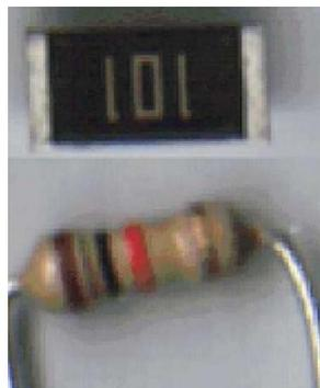
Figura 5 - Imagem de um resistor SMD (acima) e um resistor de carbono (abaixo).
