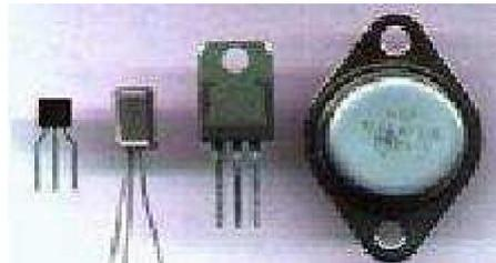
*Figura 6 - Modelos de transistores existentes.*
