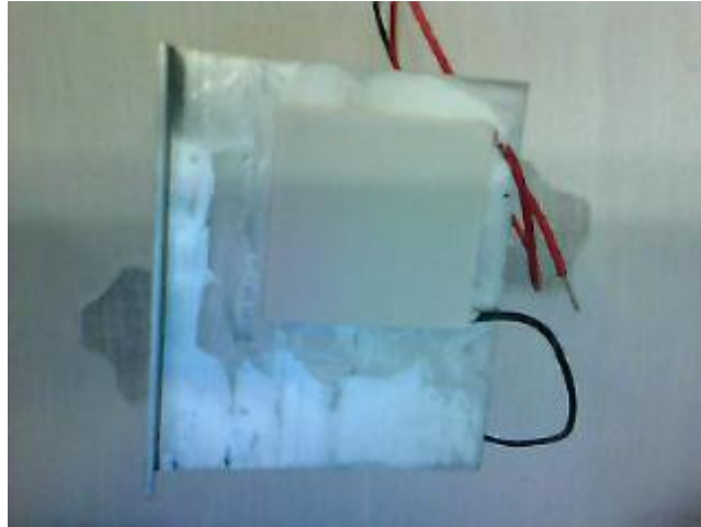
Figura 3 – Circuito da célula peltier
