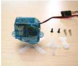
Figura 1 - Servo motor
