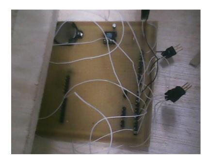
Foi criado para montagem do circuito e otimização do projeto uma placa de fenolite que conduz os 5V, o aterramento e o circuito do LCD.
