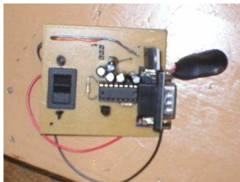
Circuito do conversor Serial-TTL montado
