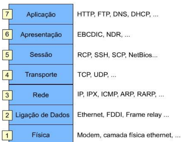
Figura 4: Estrutura do modelo OSI
