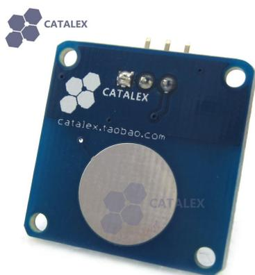
Figura 3 – Sensor capacitivo (Fonte: Catalex)
