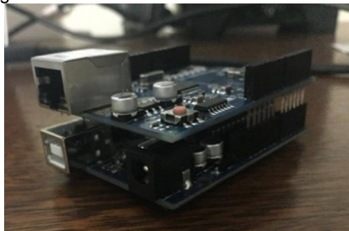
Figura 4: Arduino UNO R3 com Ethernet Shield
