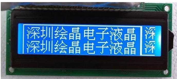
Figura 7 - *Display* LCD 16x2
