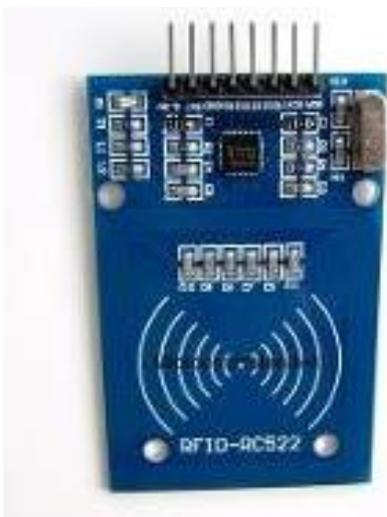
Figura 5 - Módulo RFID MCR522.
