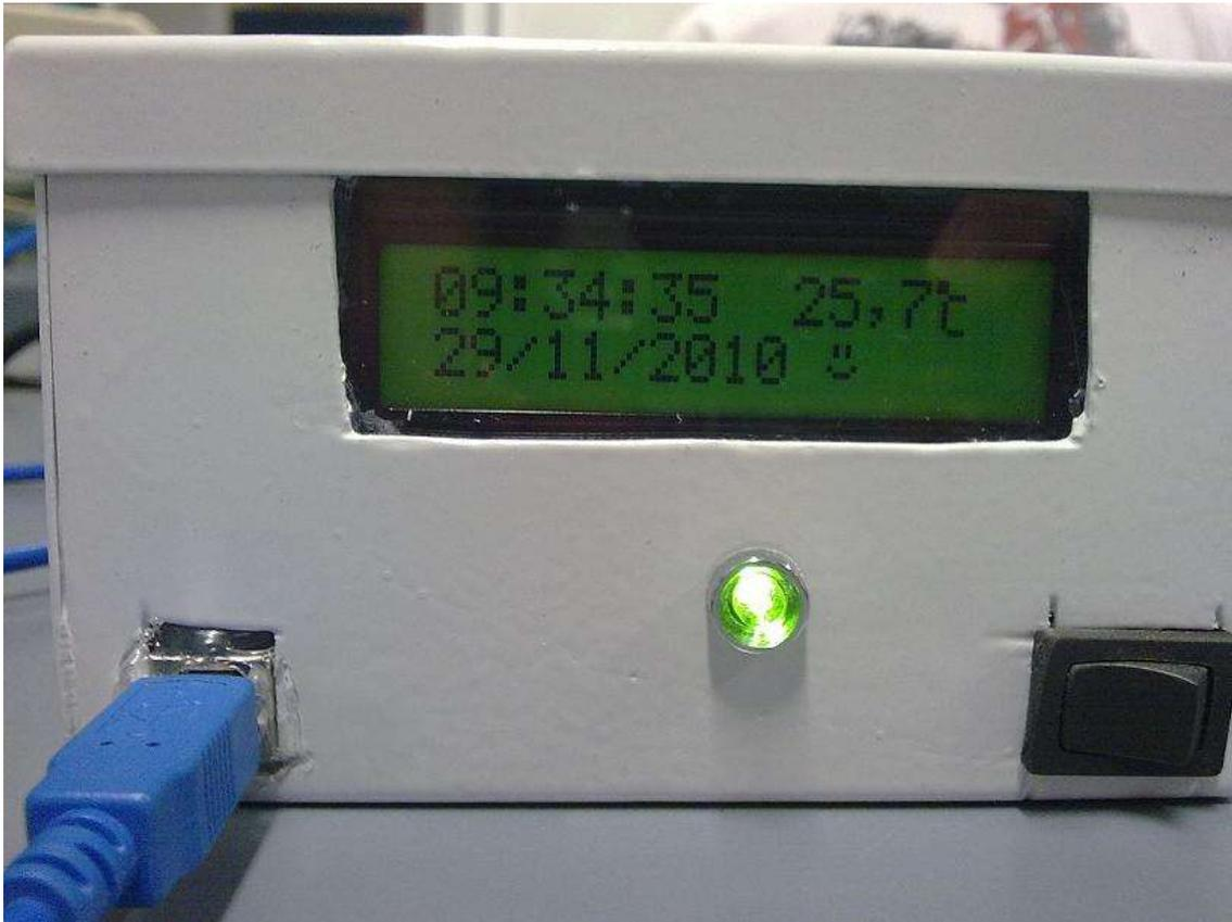
Figura 5.1 – Foto mostrando a caixa de alumínio que contém todo o projeto.
