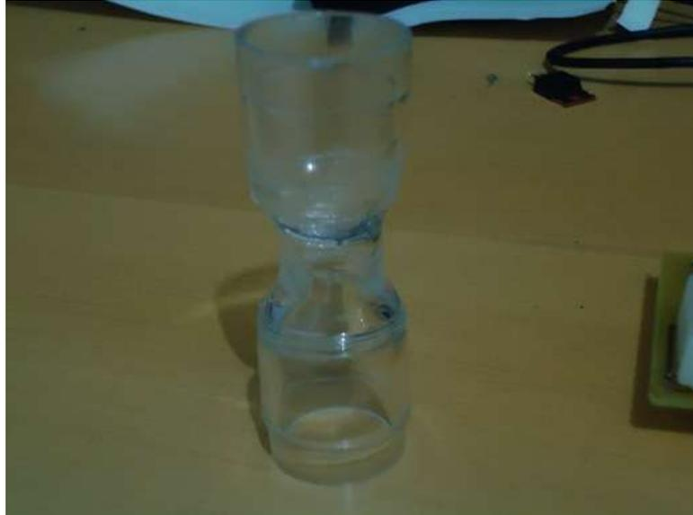
Figura 5 – O tubo deformado. Anteriormente envolto por um eletroímã, o qual ficou ligado por alguns minutos aquecendo o suficiente para derreter parte do tubo
