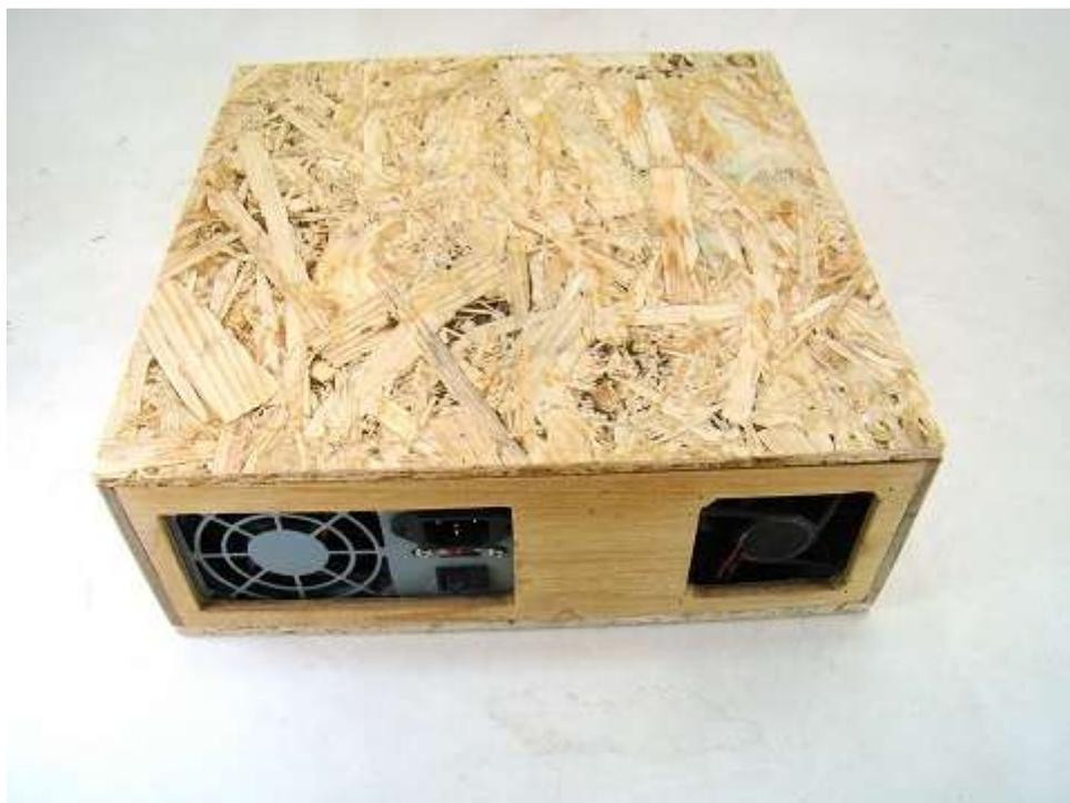
Figura 8 – A caixa em MDF, já com a fonte e o cooler montados
