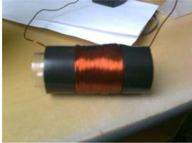
Figura 6 – Estrutura final do eletroímã
