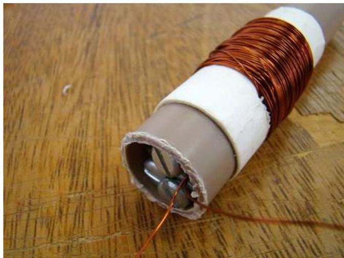
Figura 4 – O primeiro eletroímã construído para testes, recheado por diversos parafusos e pregos de variados tamanhos
