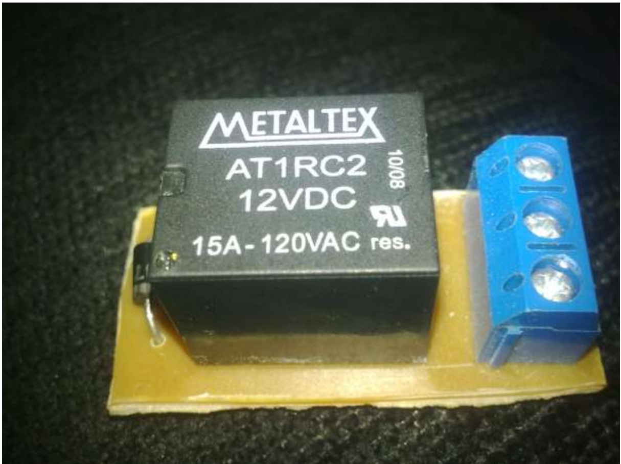
Figura 05: Relê controlador da fonte AT
