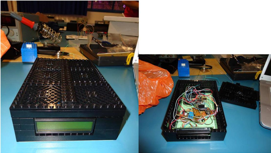
Figura 9 – Caixa com display, DTMF, amplificador e arduino
