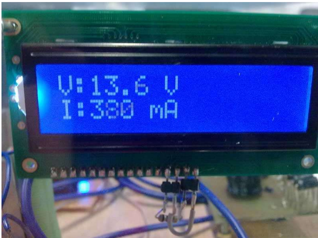
Figura 4.2 – Display da fonte que exibe tensão e corrente.
