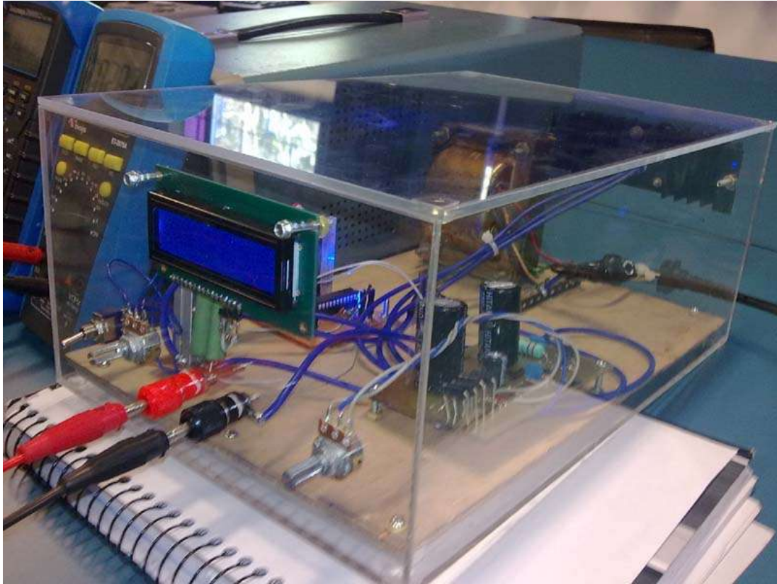
Figura 4.0 – Foto mostrando a fonte com todos os componentes embarcados.
