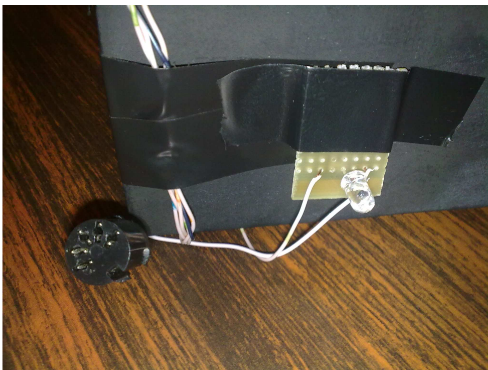
Saída do LDR para o led na lateral
