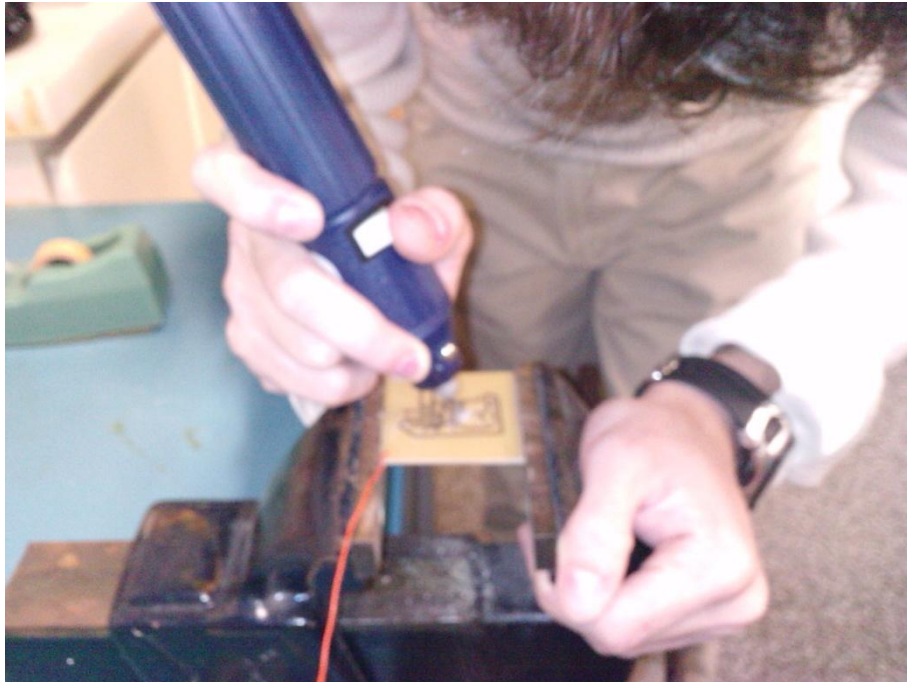
Figura 2.1 (Ajustes na placa NOT)
