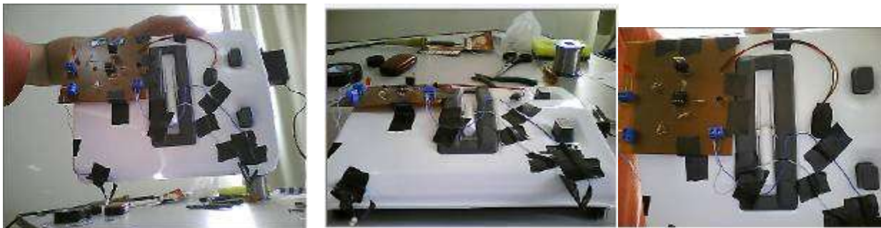
Estrutura montada junto com o circuito elétrico e os servos motores
